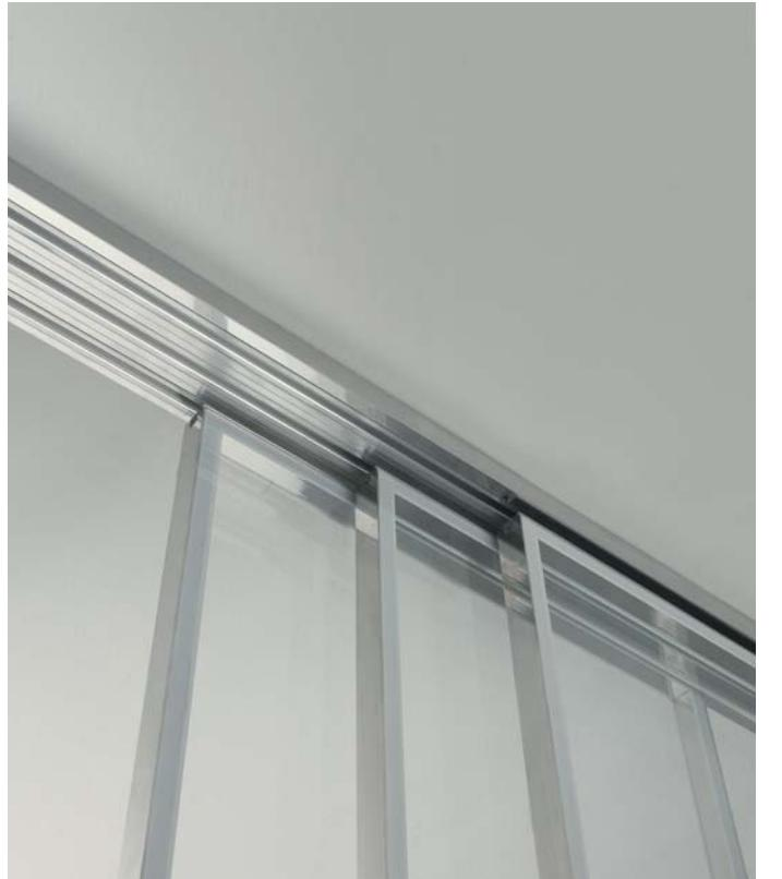
Pan nelle versioni con binario a tre vie esterno ed incassato nel controsoffitto. La versione con il binario incassato si compone di un profilo da installare durante la posa del controsoffitto e di un binario di scorrimento da montare successivamente, al momento di mettere le porte.
